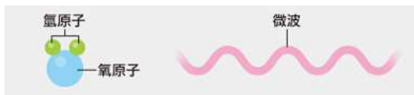
圖二、水分子受微波震盪示意圖
