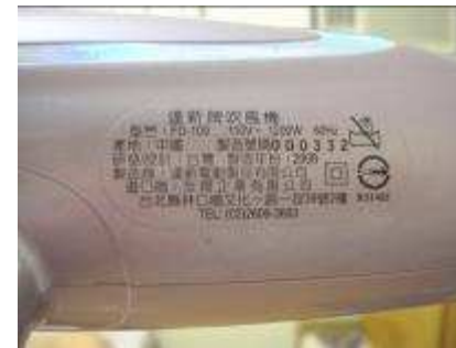
吹風機的標籤有標示瓦數 1200 瓦=1.2 千瓦 使用約 50 分鐘為 1 度
