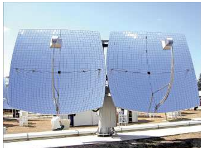
聚焦光電技術的硬體部分，包括布滿玻璃鏡片10平方公尺面盤，及與面盤相連，吸收鏡片反射日照的一部10釐米見方大小光電池板。
